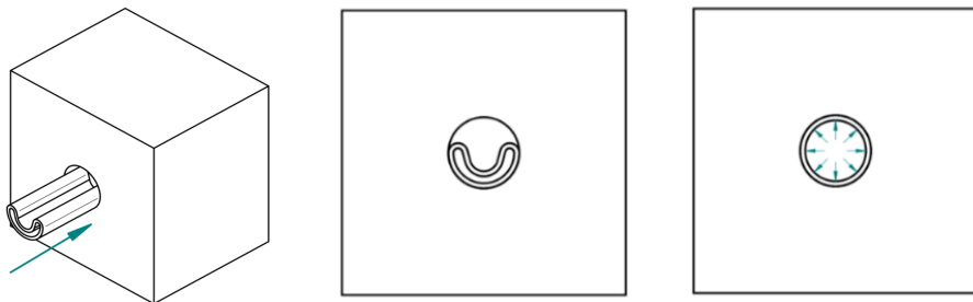
Рис. 6. Установка теплоизоляции в канал трубы.
